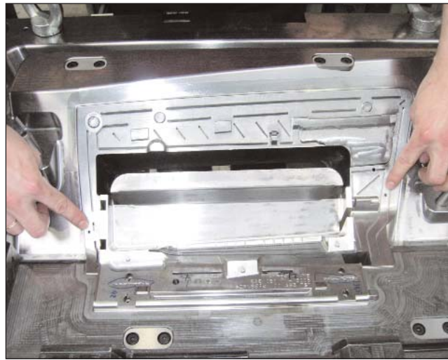
Anspritzpunkte im Werkzeug für den angussfreien Spritzguss
